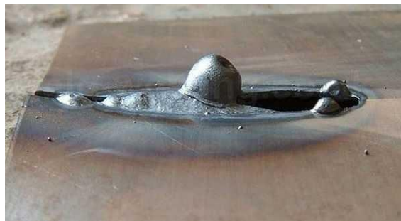
Так выглядит прожог шва при сварке
