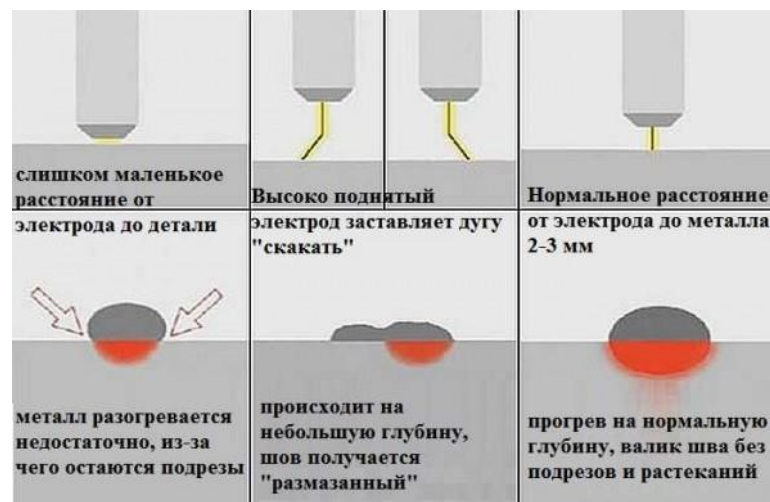
Длина сварочной дуги и ее влияние на качество шва
