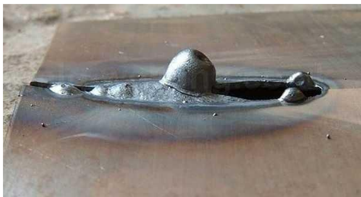
Так выглядит прожог шва при сварке
