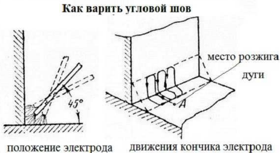
Сварка углового шва — положение и движение электрода
