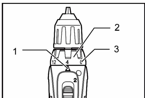
выполнением работы сначала закрутите пробный шуруп в материал или в деталь из аналогичного материала.
