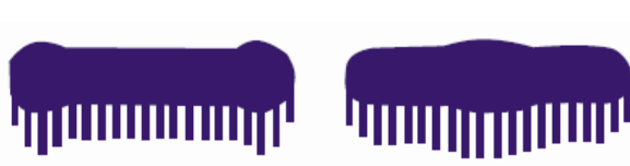
Образцы с неправильным распределением материала в факеле
