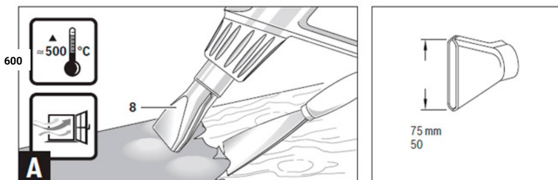
Насадите плоское сопло. Размягчите лак горячим воздухом и снимите его острым, чистым шпателем. Продолжительное воздействие тепла ведет к сгоранию лака и осложнению его удаления.
