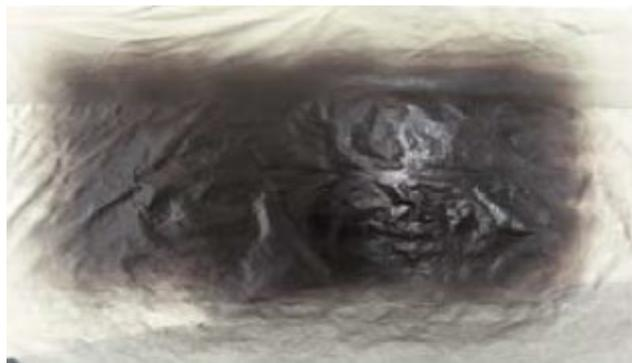
Не следует пытаться добиться очень мелких капелек одинакового размера. Размер капель зависит как от давления распыления, так и от степени помола пигмента. Поэтому равномерное распределение по отпечатку более мелких капель, чем остальные, можно считать нормальным. Также нормально, когда от центра отпечатка к верхней и нижней его части размер капель слегка уменьшается.
