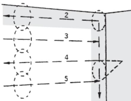
Для получения более качественного покрытия, каждая сторона угла окрашивается отдельно. Первым вертикальным проходом окрашивается одна сторона угла, после чего горизонтальными проходами красится основная поверхность. С другой стороны, проделывается то же самое, не заходя на уже окрашенную смежную зону.
