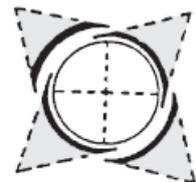
Цилиндрические изделия большого диаметра окрашиваются также, как и плоские, с той лишь разницей, что секции должны быть короче. Цилиндры маленького диаметра лучше окрашивать вдоль, вертикальными проходами.
