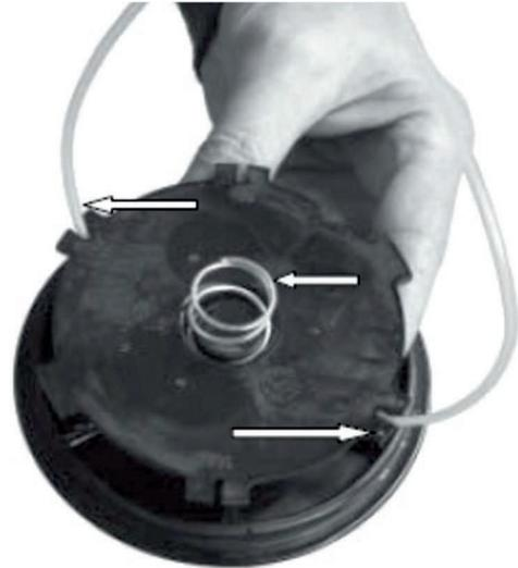
Намотайте корд плотно с натягом по часовой стрелке в пазы на катушке. Вставьте концы лески в пазы на корпусе катушке. Убедитесь в наличии пружины в катушке.
