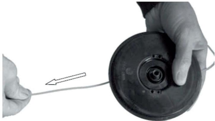
Вставьте концы лески в отверстия на корпусе катушке и установите катушку в корпус. Освободите концы корда, потянув за концы от центра, при этом нажимая вниз на катушку.
