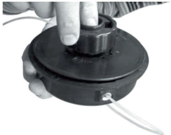
Поверните катушку по часовой стрелке примерно на 10 градусов и зафиксируйте ее в корпусе. Закрутите гайку крепления катушки.
