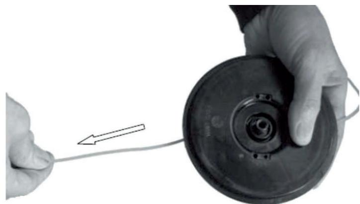
Вставьте концы лески в отверстия на корпусе катушки и установите катушку в корпус. Освободите концы корда, потянув за концы от центра, при этом нажимая вниз на катушку.
