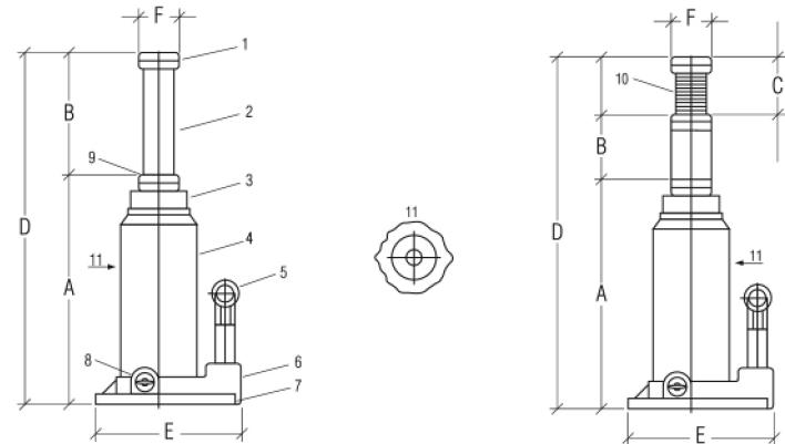
1 - опорная площадка, 2 - шток, 3 - верхняя крышка, 4 - гидравлический цилиндр, 5 - привод гидравлического насоса, 6 - гидравлический насос, 7 - основание домкрата, 8 - запорная игла (клапан), 9 - уплотнительное кольцо, 10 - выдвижной удлинительный винт, 11- заливное отверстие (расположено на задней поверхности гидроцилиндра).
