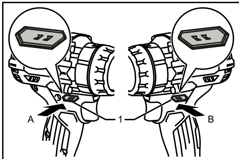
Пользуйтесь реверсивным выключателем только после полной остановки инструмента. Изменение направления вращения до полной остановки инструмента может привести к его повреждению.
