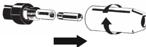
Снимите сопло и контактную трубку.
