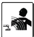
Сварочные аппараты излучают электромагнитные волны и создают помехи для радиочастот, поэтому следите за тем, чтобы в непосредственной близости от аппарата не было людей, которые используют стимулятор сердца или другие принадлежности, для которых электромагнитные волны и радиочастоты создают помехи.
