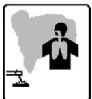
Дым и газ, попадающие в воздух при сварке, опасны для здоровья. Перед началом работ убедитесь, что вытяжка и приточная вентиляция исправно работают.
