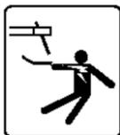
Избегайте контактов с открытыми токоведущими кабелями сварочного аппарата, не прикасайтесь к держателю электрода и свариваемой поверхности. Не прикасайтесь к месту подключения питания или к другим частям сварочного аппарата, которые находятся под током. Отключайте питание сразу после окончания работы или перед тем, как оставите рабочее место.
