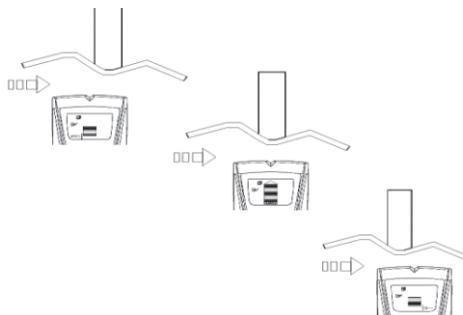
**! Se estiver a receber resultados de leitura irregulares, pode ser por causa de humidade, humidade na cavidade da parede ou no drywall, ou tinta recentemente aplicada ou papel de parede que não esteja totalmente seco.**
