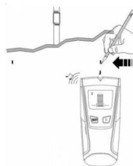
Metal nesnenin yerini daha kesin olarak tespit etmek için, önceden işaretlenmiş iki nokta içinde kalibre ederek cihazın hassasiyetini azaltın. Metal tespit edilen yüzeyde kalibrasyon yapmak hassasiyeti azaltır ve arama alanını daraltır. Kalibrasyon tamamlandıktan sonra, önceden işaretlenmiş iki nokta içinde yukarıda belirtilen adımları tekrarlayın. Arama alanını daha da daraltmak ve metal nesnenin kenarlarını daha doğru bir şekilde bulmak için cihazın hassasiyetini birkaç kez azaltabilirsiniz.
