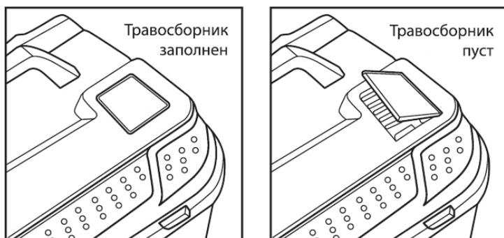
Как только вы заметили движение индикатора наполнения, отключите газонокосилку и опорожните травосборник. Для выключения газонокосилки отпустите рычаг.
