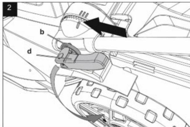
Прикрепите верхнюю стойку с рукояткой к нижней стойке с помощью шайбы и фиксатора с гайкой. Зафиксируйте кабель питания с помощью фиксатора кабеля питания, как показано на рисунке.
