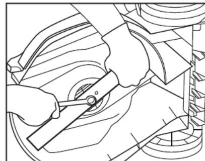
Перед снятием ножа необходимо выключить газонокосилку, отключить вилку кабеля питания от розетки и снять травосборник.
