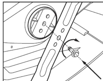
После установки ножа запустите двигатель косилки. Поработайте пару минут без нагрузки для проверки установки ножа. При возникновении повышенной вибрации немедленно остановите устройство и обратитесь в авторизованный сервисный центр.
