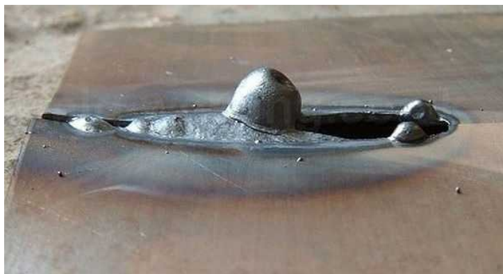
Так выглядит прожег шва при сварке
