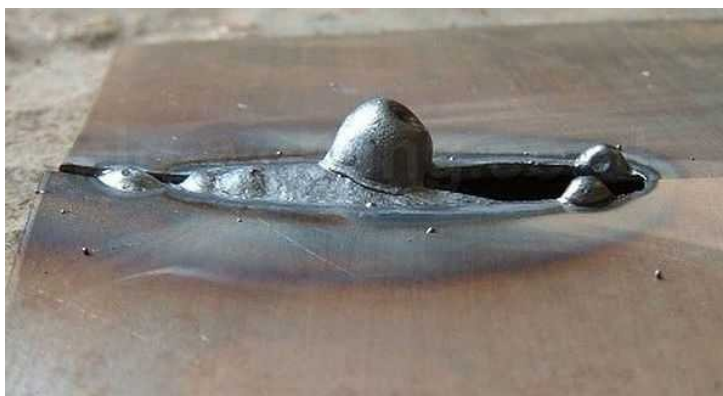
Так выглядит прожог шва при сварке
