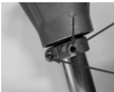
Совместите отверстие трубы с отверстием верхнего редуктора
