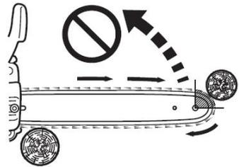
**⚠ ВНИМАНИЕ! В случае заклинивания пилы в дереве, немедленно выключите ее! Расклинивание пильной шины производить только на выключенном инструменте!**
