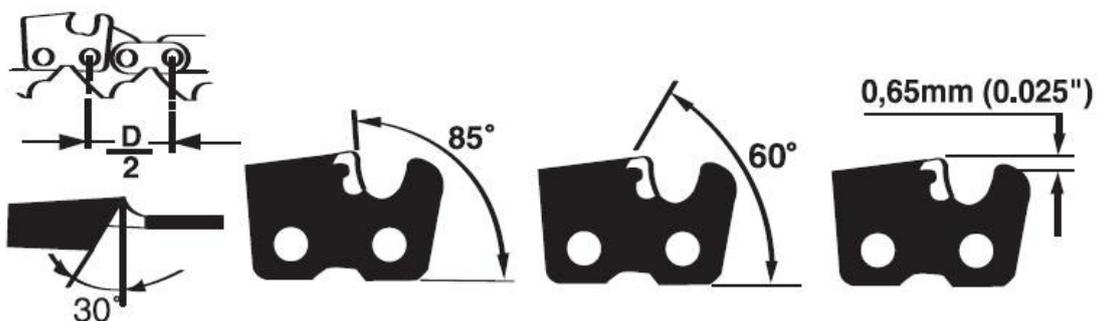
**⚠ ВНИМАНИЕ!** После того как Вы самостоятельно производили заточку режущих зубьев 3-4 раза, следует обратиться в сервисный центр. Специалисты смогут переточить ограничители глубины, что позволит скорректировать расстояние до режущей грани.
