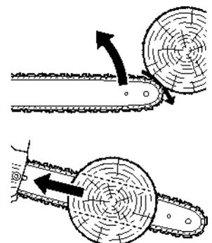
**касании носком пильной шины какого-либо предмета, а также при защемлении пилы в резе.**
