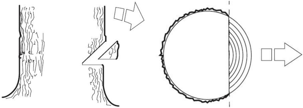
Линия, на которой сходятся два этих пропила, называется направляющей линией. Эта линия должна быть строго горизонтальной и составлять прямой угол (90 градусов) к предполагаемому направлению падения.
