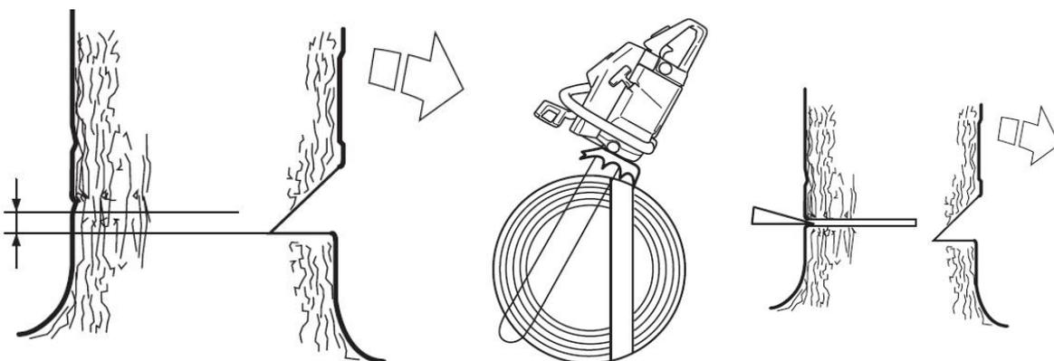
Закончить основной пропил нужно параллельно линии направляющего пропила так, чтобы расстояние между ними составляло около 1/10 диаметра ствола. Нераспиленный участок ствола называется полосой разлома.
