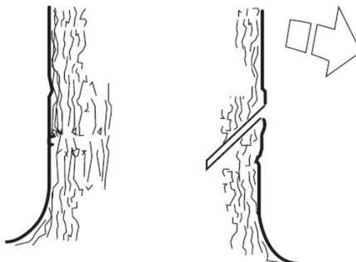
После этого делается нижний пропил так, чтобы он сошелся с концом верхнего пропила. Направляющий пропил делается на глубину 1/4 ствола и угол между верхним и нижним пропилом должен быть не меньше чем 45 градусов.
