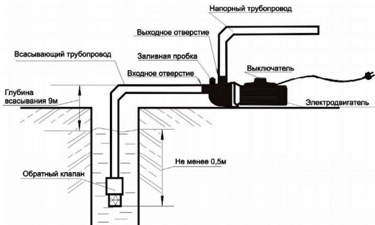
Чтобы избежать протечек и потери давления, соединения трубопроводов должны быть абсолютно герметичными. Даже небольшой подсос воздуха во всасывающей магистрали резко сокращает производительность насоса и глубину всасывания.
