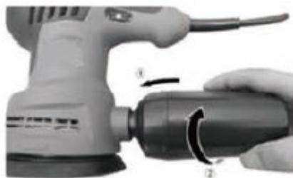
Для подключения пылесборника вставьте его переходник в пылесборное отверстие с задней стороны ЭШМ.
