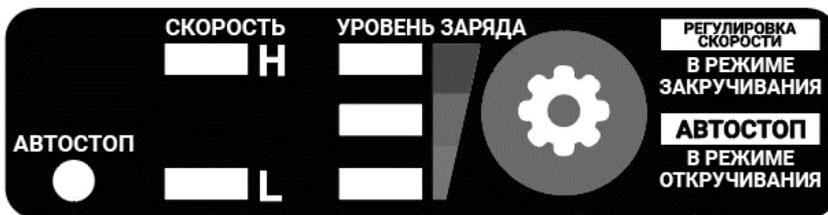
Данный гайковерт также оснащен индикатором заряда батареи. Если горят три световых индикатора заряда батареи, то батарея заряжена. Если горит один световой индикатор заряда батареи, то батарея разряжена, либо ее заряд на исходе.
