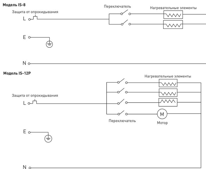
Схема устройства может незначительно отличаться.
