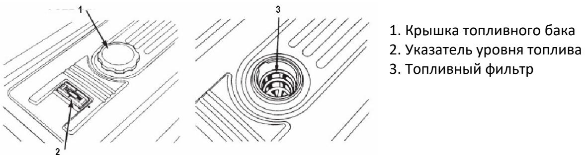
Используйте неэтилированный бензин с октановым числом не ниже 92. Не допускайте попадания воды и грязи в топливный бак.
