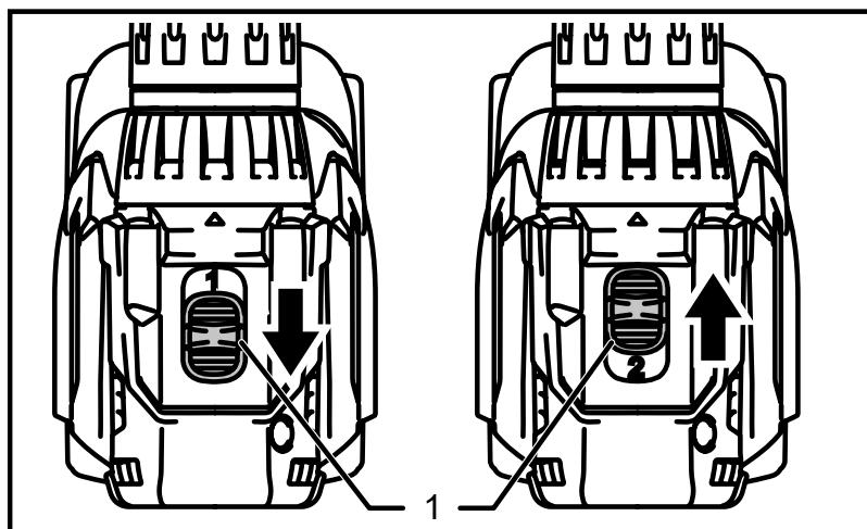
**ПРЕДУПРЕЖДЕНИЕ!** Всегда полностью переводите переключатель передач в правильное положение. Если Вы работаете с инструментом, а переключатель передач находится посередине между обозначениями "1" и "2", это может привести к повреждению инструмента.
