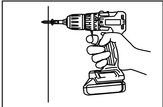
**ПРЕДУПРЕЖДЕНИЕ!** Следите за тем, чтобы насадка вставлялась прямо в головку винта, иначе можно повредить винт и/или саму насадку.
