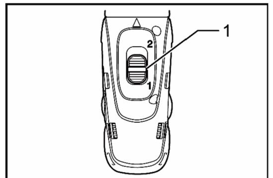
1-я скорость — предназначена для закручивания и откручивания, а также для работы со сверлами больших диаметров.
