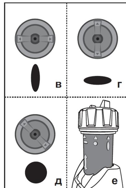
При пробной окраске определите необходимую скорость ведения распылителя для равномерной окраски и расход материала, во избежание, при большой скорости и недостаточном расходе, неравномерного покрытия; а при низкой скорости и избыточном расходе –потечков материала. Регулировка расхода материала осуществляется вращением регулятора 1.
