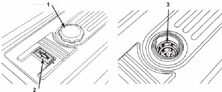
1. Крышка топливного бака
