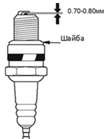
**⚠ ВНИМАНИЕ!** Для обеспечения правильной работы двигателя, свеча зажигания должна быть правильно подобрана.
