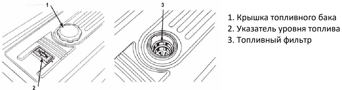
Используйте неэтилированный бензин с октановым числом не ниже 92. Не допускайте попадания воды и грязи в топливный бак.
