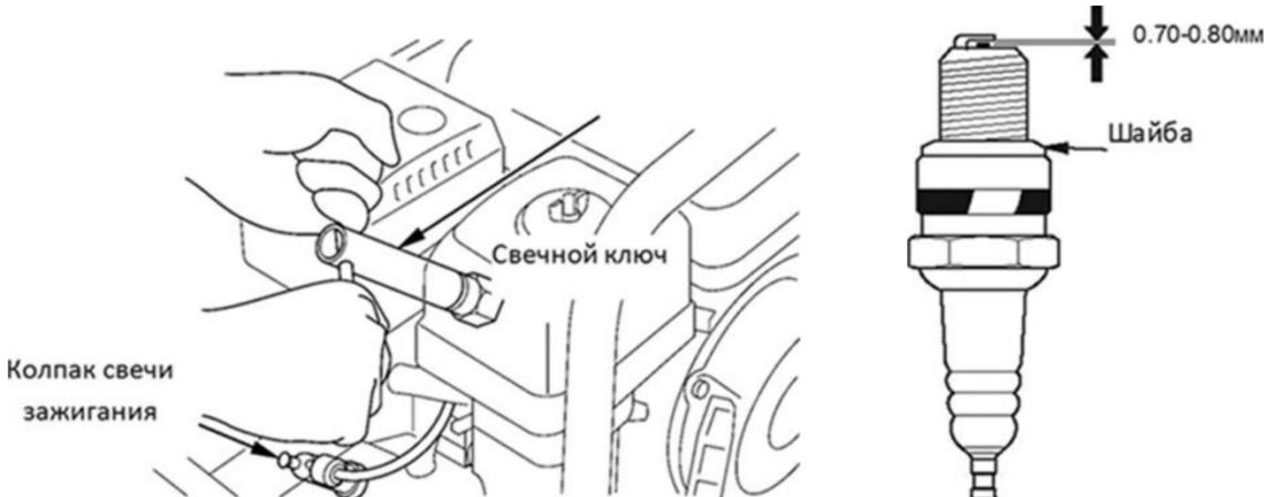
**⚠ ВНИМАНИЕ!** Для обеспечения правильной работы двигателя, свеча зажигания должна быть правильно подобрана.
