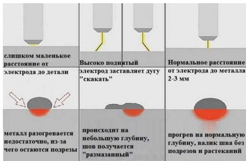
Длина сварочной дуги и ее влияние на качество шва
