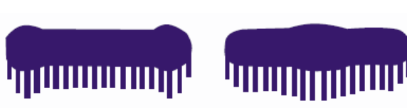
Образцы с неправильным распределением материала в факеле
