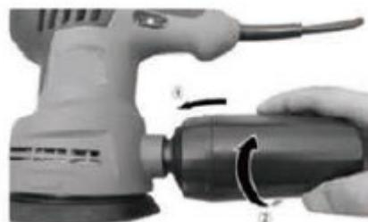
Для подключения пылесборника вставьте его переходник в пылесборное отверстие с задней стороны шлифмашины эксцентриковой.
