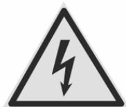
***ПРЕДУПРЕЖДЕНИЕ!** Станок по классу защиты от поражения электрическим током относится к низковольтному оборудованию I класса. Это означает, что для предотвращения поражения пользователя электрическим током, станок должен быть обязательно заземлен через розетку с заземляющим контактом.*
