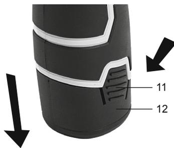
6.2.4 Отсоедините аккумулятор (12) от электроинструмента путем нажатия на фиксатор (11) и подключите к нему зарядное устройство.
