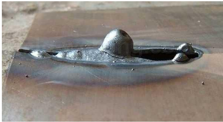
Так выглядит прожог шва при сварке
