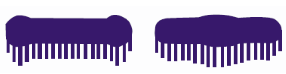
Образцы с неправильным распределением материала в факеле
